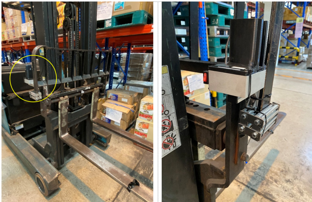
การติดตั้งเซนเซอร์วัดความสูงและตรวจจับพัลเลต
