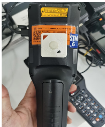
การติดตั้งแท็ก BLE ที่อุปกรณ์สแกนเนอร์และคอมพิวเตอร์พกพา
