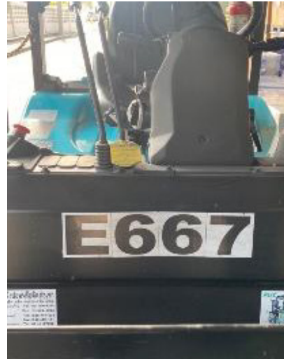
ตำแหน่งติดตั้งแท็ก BLE ที่รถฟอร์กลิฟต์
