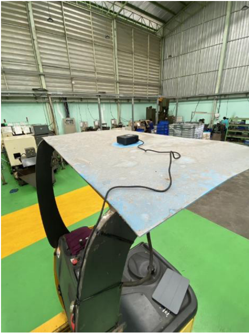
การติดตั้งแท็กพลาสต์ UWB บนรถฟอร์กลิฟต์
