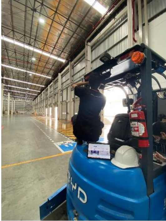
การติดตั้งแท็กพาส UWB กับรถฟอร์กลิฟต์
