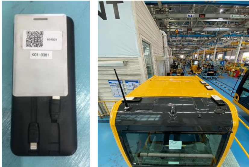
การติดตั้งอุปกรณ์ UWB tag
