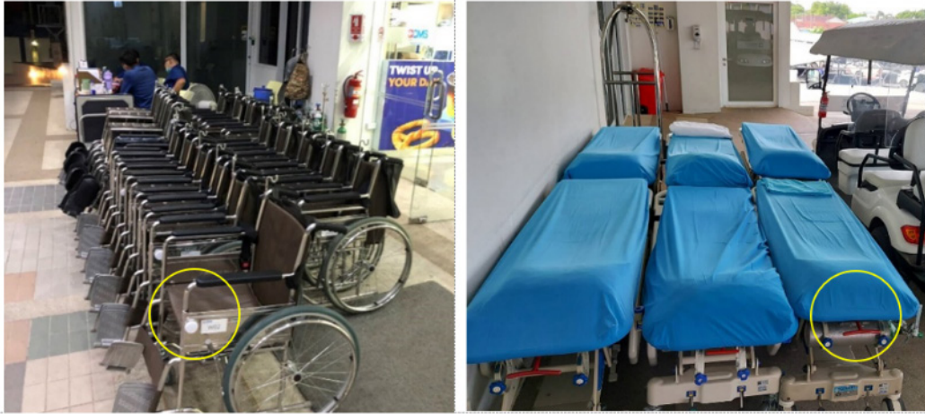
การติดตั้งแท็ก BLE กับรถเข็นและเตียงนอน
