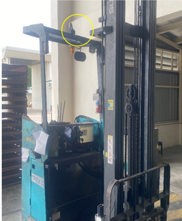
การติดตั้งแท็กพลาส UWB ที่รถฟอร์กลิฟต์
