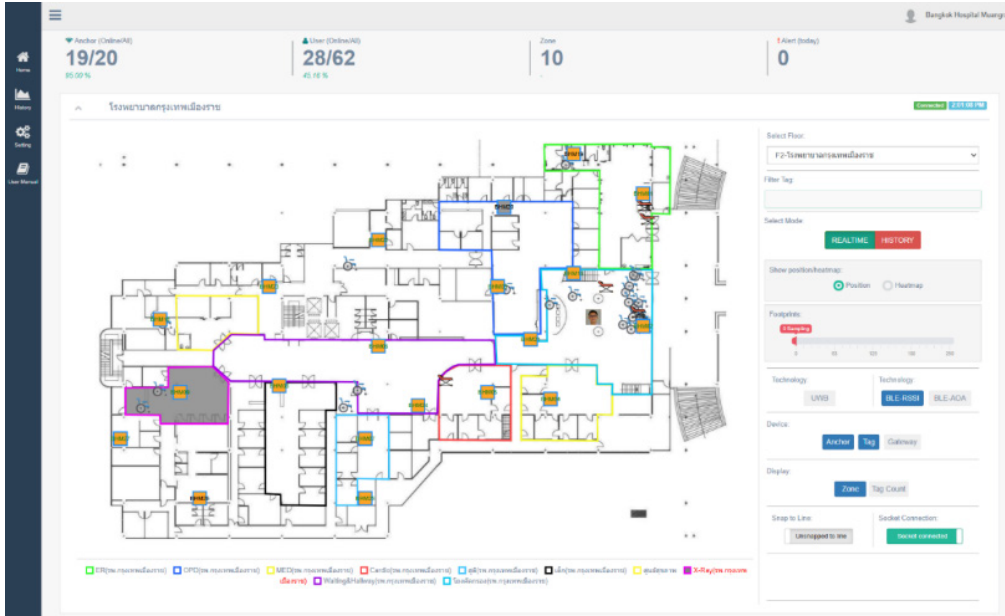
ตัวอย่างหน้าจอแสดงผลการติดตามรถเข็นและเตียงผู้ป่วยในโรงพยาบาล เป็นระบบที่ใช้การติดตามตำแหน่งแบบพิกัด (x, y) ไอคอนสี่เหลี่ยมสีส้มแทนตำแหน่งแองเคอร์ BLE ที่ติดตั้ง และไอคอนรูปรถเข็นและเตียงนอนแทนตำแหน่งของอุปกรณ์
