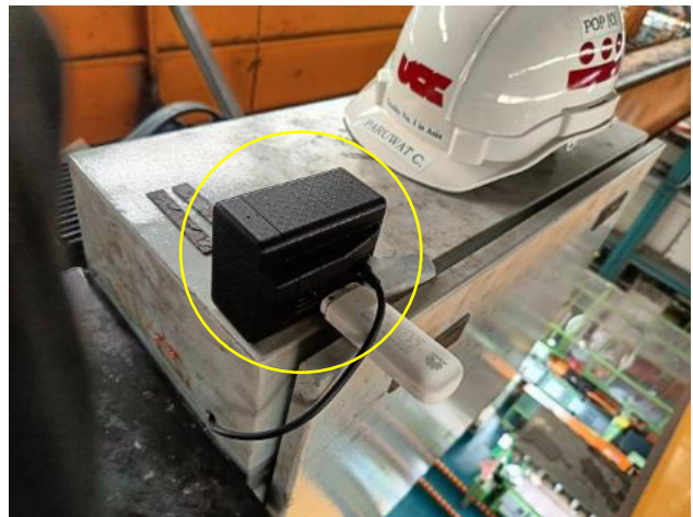
การติดตั้งแท็กพลาส UWB กับเครนยก
