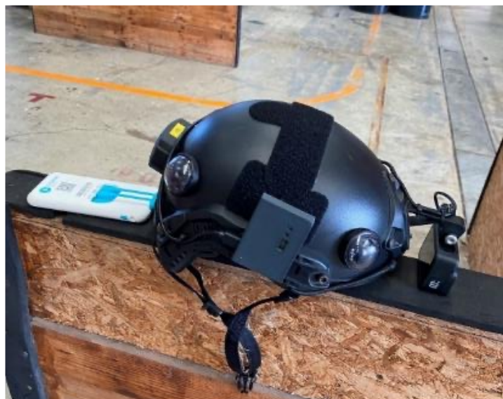
การติดตั้ง UWB แท็กเข้ากับหมวก
