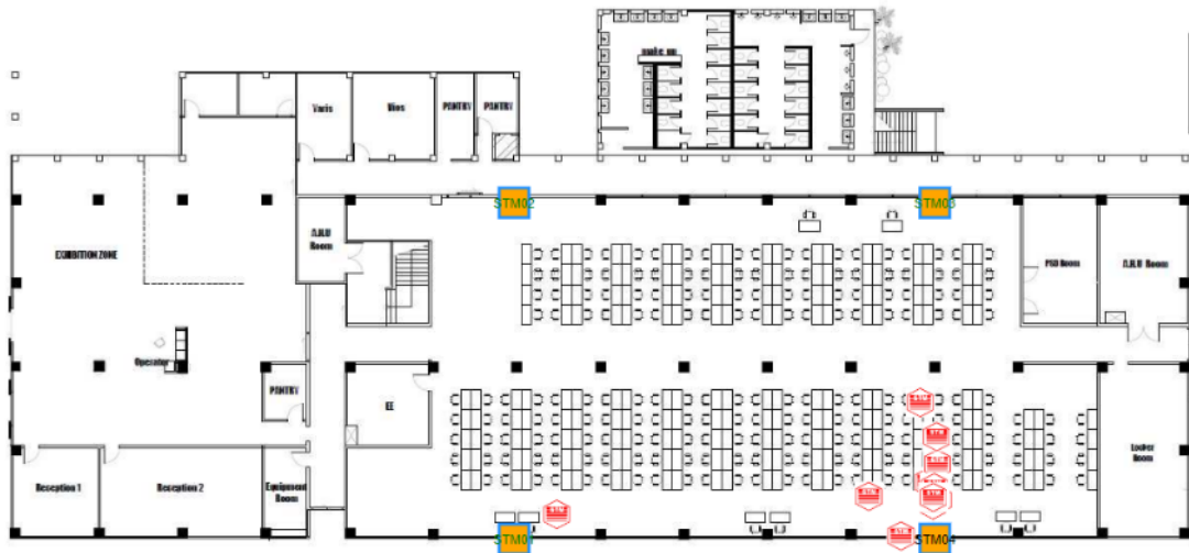
ตำแหน่งติดตั้งแองเคอร์ BLE ในสำนักงาน
