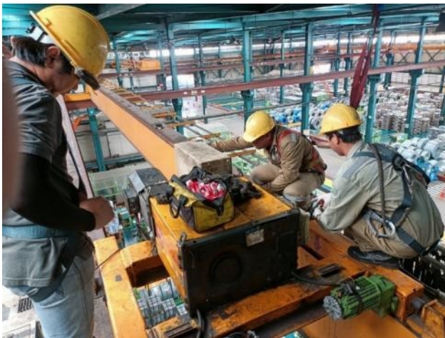
การติดตั้งแท็กพลาส UWB กับเครนยก
