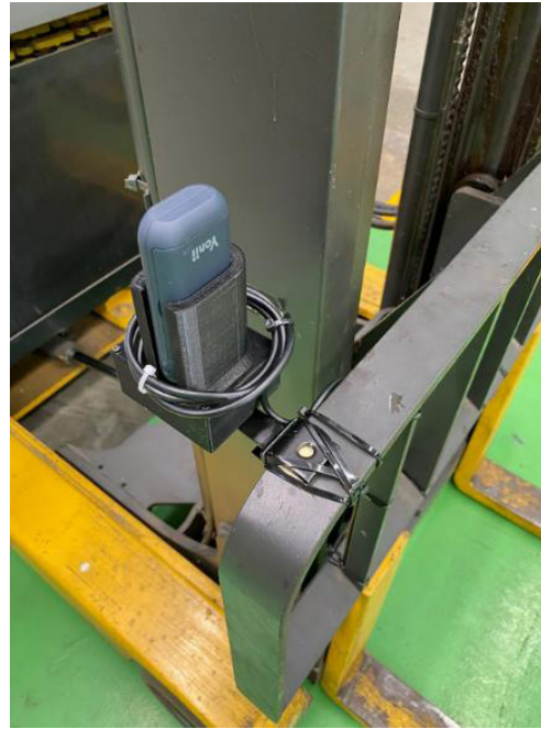
การติดตั้งเซนเซอร์วัดความสูงและตรวจจับพัลเลต
